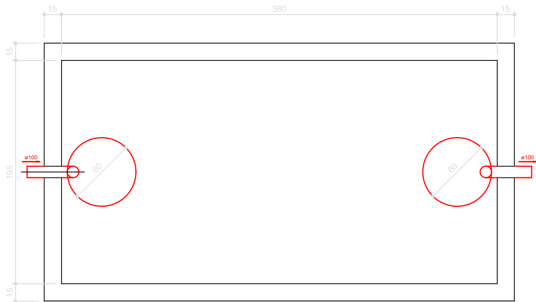
TANQUE SÉPTICO PLANTA BAIXA - ESC. 1:25
